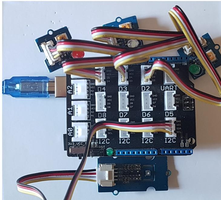
LED verte branchée sur D2, LED orange sur D3, LED rouge sur D4
