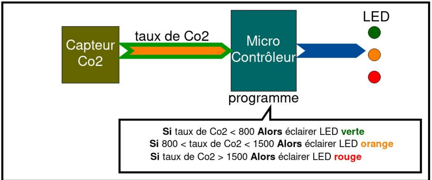
Deux capteurs sont disponibles dans la technologie utilisée pour ce projet : le SCD30 et le SGP30
