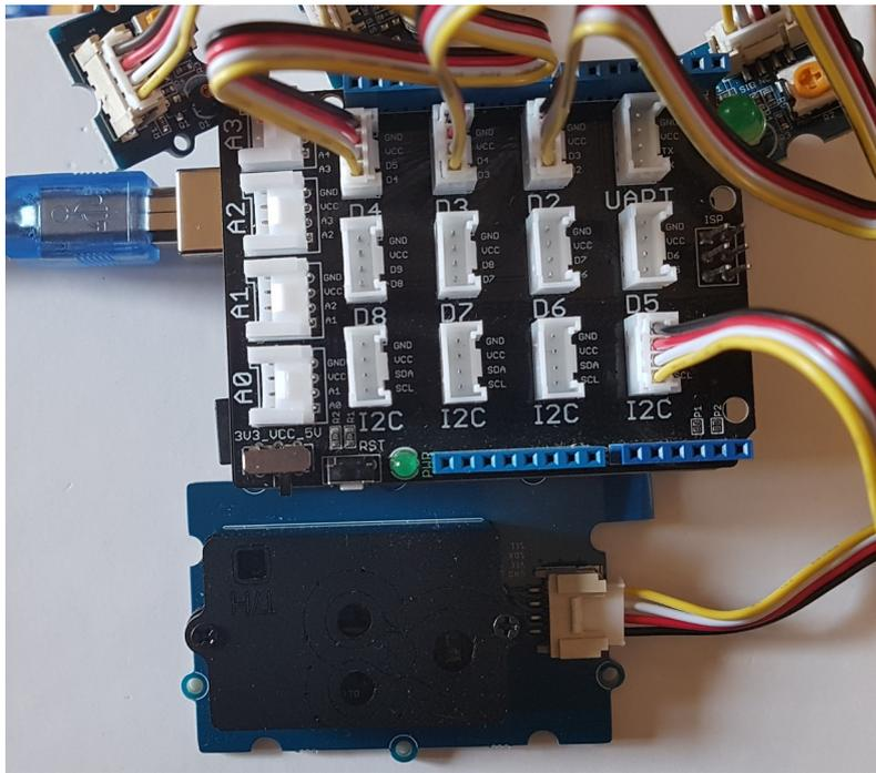
LED verte branchée sur D2, LED orange sur D3, LED rouge sur D4
