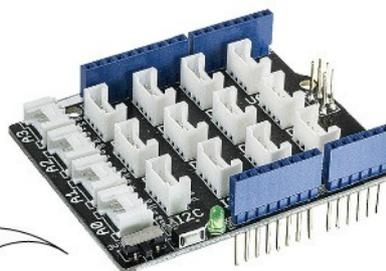
3- Relier les capteurs et actionneurs à la carte fille à l'aide des câbles
