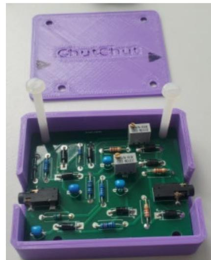
Figure 24 : Les différents prototypes de boîtiers imprimés
