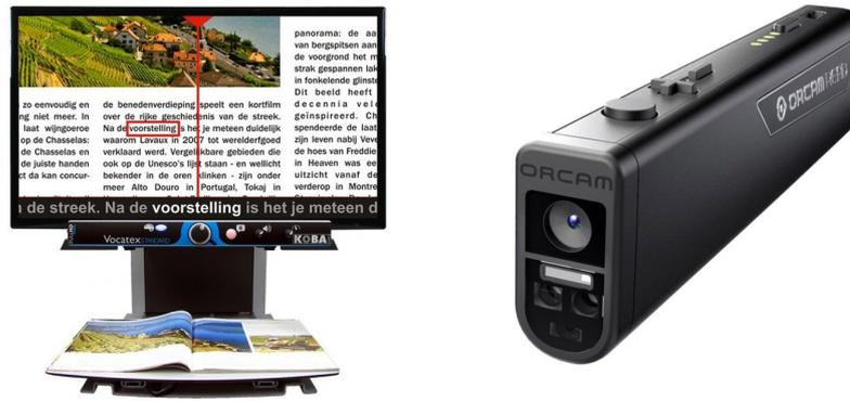
Figure 31 : Téléagrandisseur parlant Vocatex+ et le Stylo Orcam Read Smart
