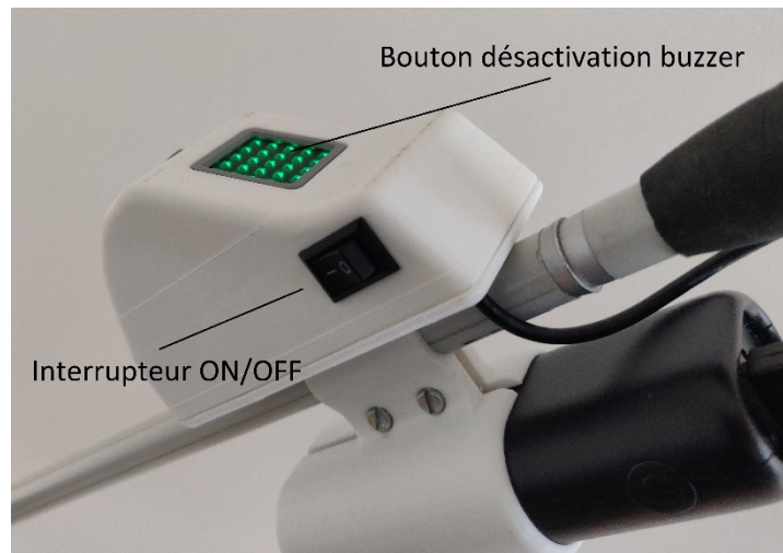
Figure 8 : Boîtier avec interrupteur ON/OFF et bouton désactivation du buzzer
