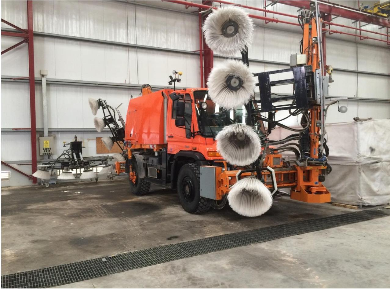
« Pour nettoyer les capteurs salis par la poussière, on a fabriqué spécialement trois gigantesques tracteurs munis de rouleaux nettoyeurs. Coût : sept millions de dollars, mais les rouleaux se prennent dans la végétation épineuse, ce qui raye les miroirs. Il devient rapidement nécessaire de couper cette végétation, et sur les 15 km<sup>2</sup> du site, cette opération n'était pas budgétée à sa juste valeur. En attendant d'une solution, les tracteurs sont à l'arrêt, inutilisables. »
