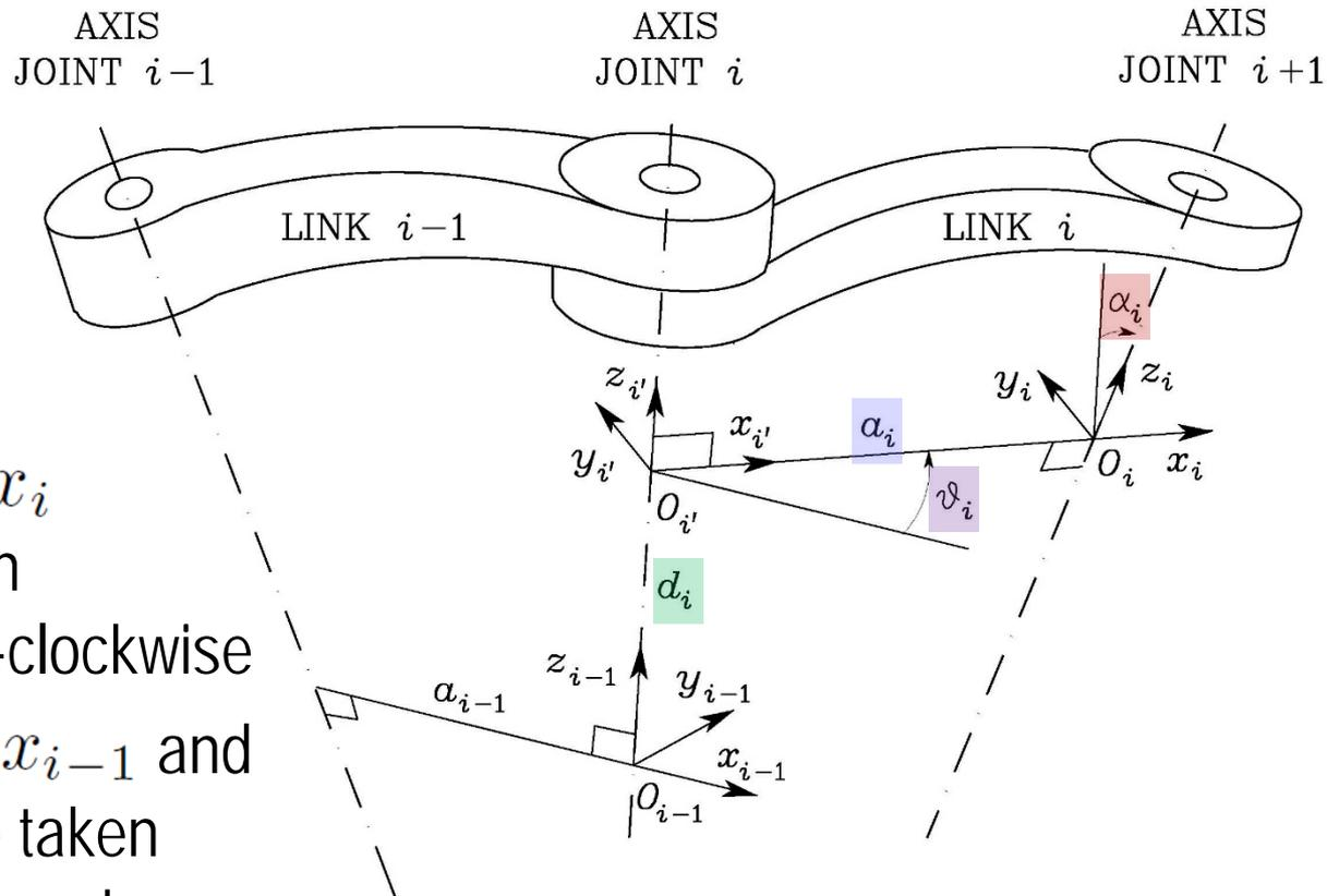
$$\mathbf{A}_{i'}^{i-1} = \begin{bmatrix} c\vartheta_i & -s\vartheta_i & 0 & 0 \\ s\vartheta_i & c\vartheta_i & 0 & 0 \\ 0 & 0 & 1 & d_i \\ 0 & 0 & 0 & 1 \end{bmatrix}$$
